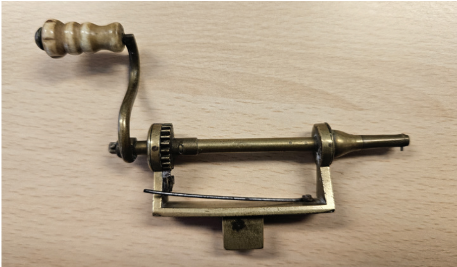
Een opwindmechanisme om een klok/horlogeveer op te winden.
