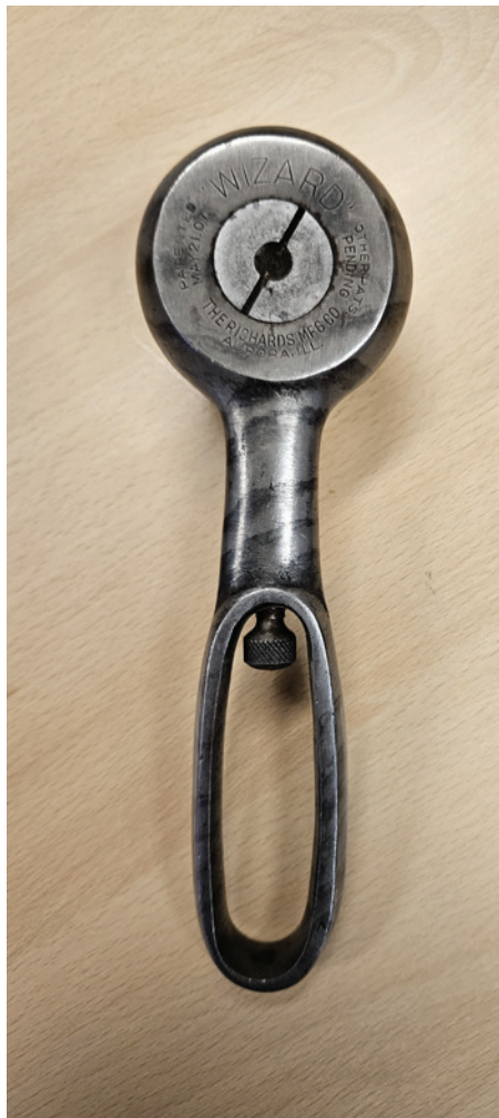
Willem Mensert toonde een bijzondere links en rechts te gebruiken, verstelbare moersleutel.
