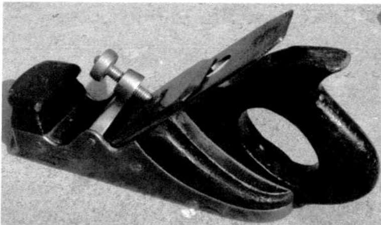
◀ Schotse blokschaaf, staal ingevuld met mahoniehout. De beitel is 52 mm breed en vatgezet met een messing beitelklem. De schaaf is niet gemerkt. Beitelmerk: Hibernia Marples.
