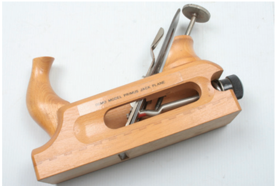
Het zeer effectieve instelmechanisme van de Primus oogt bedrieglijk simpel.
