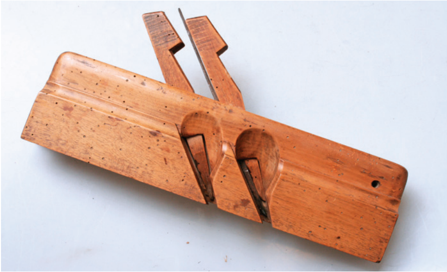
Steenbeuken profielschaaf met dubbele beitel.
