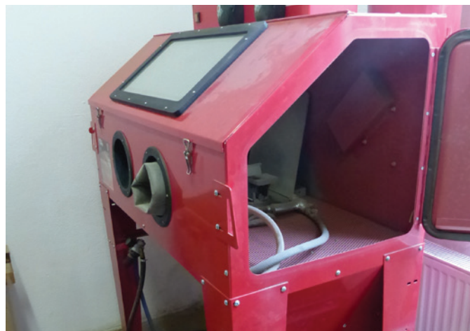
Een gritstraalmachine haalt roest en aanklonteringen weg.
