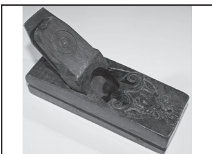
24. Bijzondere blokschaaf met datering 1721. De schaaf is gemaakt van palmhout. De slagknop is afgebroken. Wig en beitel zijn niet origineel. Geen schavenmakersmerk.
