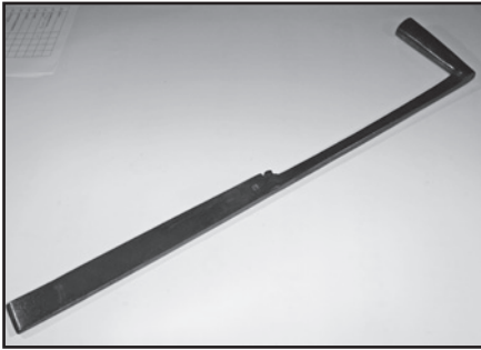
15. Hollandse snik, bijzonder smal exemplaar met aparte profielversiering. Mogelijk 18e eeuw. Smidsmerk J.A. Beitelbreedte 5 cm.
