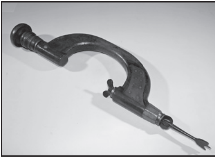
18. Houten booromslag met messing platen en bijzondere klemming voor de boorijzers.
