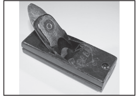
5. Schitterende blokschaaf met datering 1774. Beitel en wig zijn origineel. Het schavenmakersmerk is moeilijk leesbaar.
