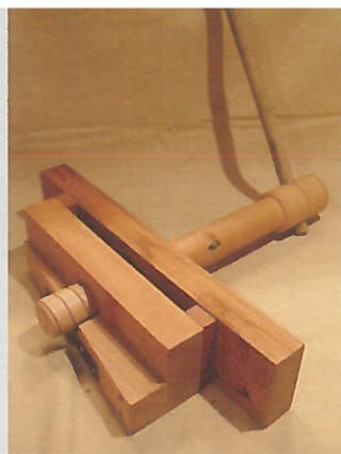
Binnendraadtap met geleidingsblok en met het te bewerken hout.
