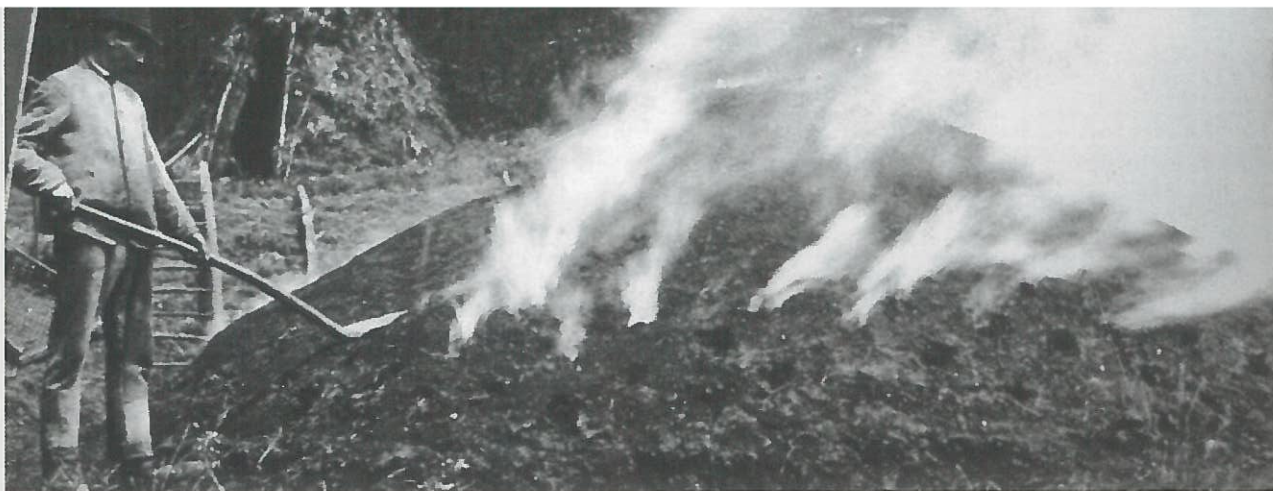
De geslonken meiler laat zien dat het branden bijna is voltooid.
