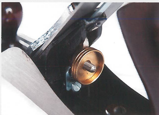
Het Bailey beitelinstelmechanisme op een Stanley nr. 5.
