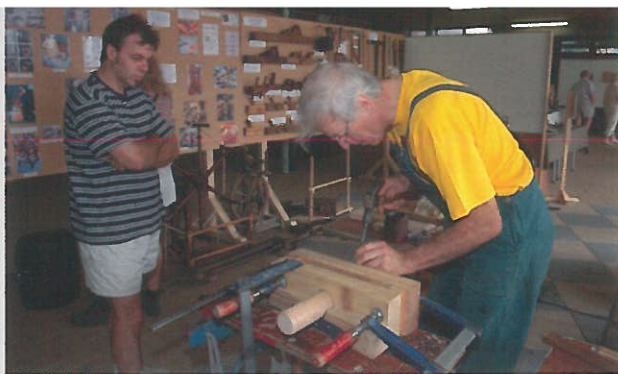
Schraper van de binnendraadtap dieper afstellen.
